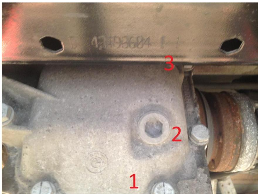
2. Differentialplatte mit den 3 mitgelieferten M10x30 Schrauben und Beilagscheiben an der rechten Seite des Differentials anbringen. Drehmomente der Tabelle (original BMW Angaben) entnehmen. Benötigtes Werkzeug: 17er Ringschlüssel
