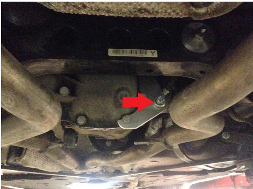
Falls das Spannelement trotz der geringsten Einstellung zu lang sein sollte, eine Kontermutter entfernen und den Gelenkkopf weiter in das Spannelement schrauben.
