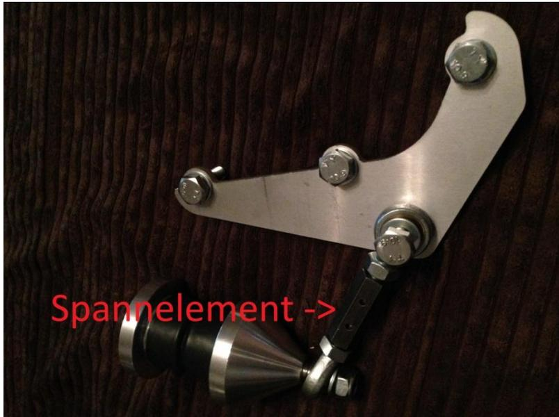
Wenn die richtige Länge des Spannelements eingestellt ist, kann dieses dann fest mit der Differentialplatte verschraubt werden (M10x40 Schraube)
