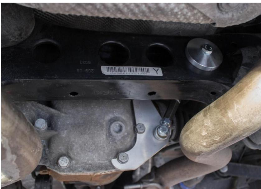
**4. An der gegenüberliegenden Seite der Hinterachse das zweite Drehteil mit dem steilen Konus auf die Schraube aufstecken und in die Hinterachse einführen.**
